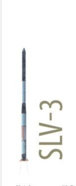
Height : 22.7m Lift-off weight : 17 t Propulsion : All Solid Payload mass : 40 kg Orbit : Low Earth Orbit
